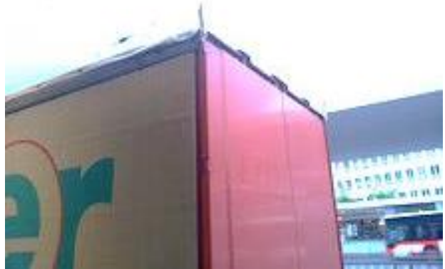
Wechselbehälter mit aufgesetztem Holzprofil an der Eckkante für die Testfahrt nach Arosa.
