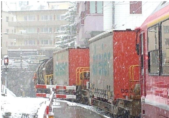
Wechselbehälter mit aufgesetztem Holzprofil an der Eckkante für die Testfahrt nach Arosa.
