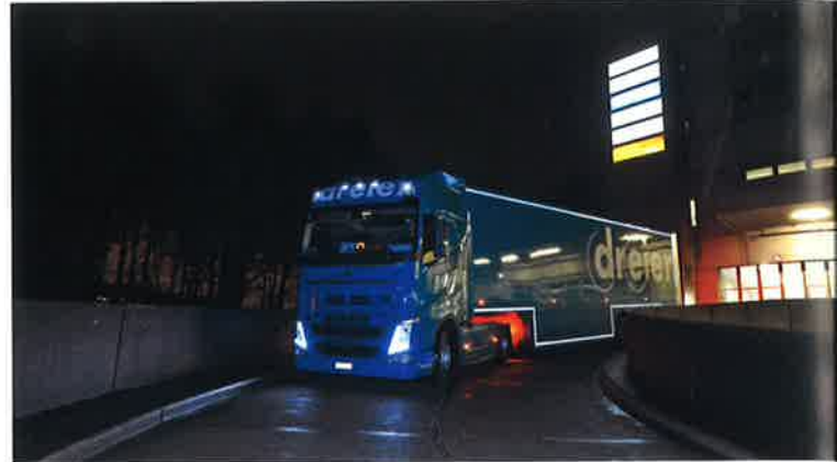
Abwärts zur Beladung: Beim Wechsel zur tief gelegenen Ladeebene ist beim Fahrbahnknick auf die Bodenfreiheit zu achten.
