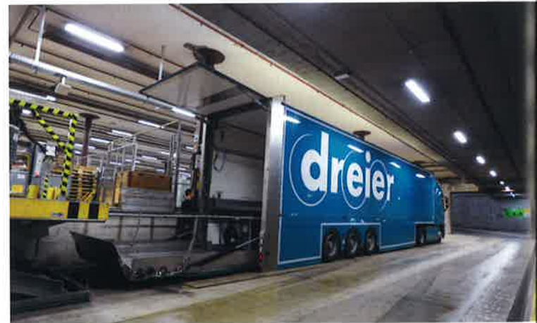
Andocken mit abgesenkter Ladebordwand und oberem Ladeboden.
