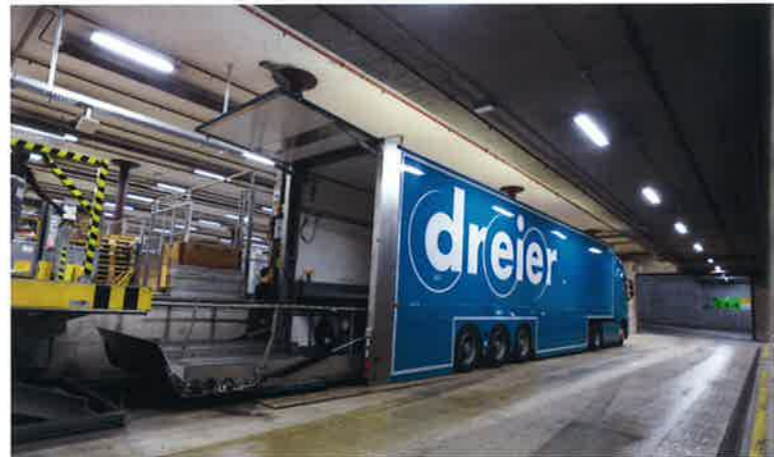
Andocken mit abgesenkter Ladebordwand und oberem Ladeboden.
