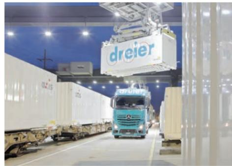
la empresa trata de reducir la cantidad de camiones en ruta. Actualmente utilizan 21 remolques de dos plantas de 1,83 metros de altura interior cada una, en las cuales pueden transportar hasta un 50 % más contenedores RX e incluso hasta un 60 % más europaletas que en un remolque convencional. “Con dos remolques de dos plantas podemos cubrir la capacidad de carga de tres vehículos convencionales”, explica el gerente.
