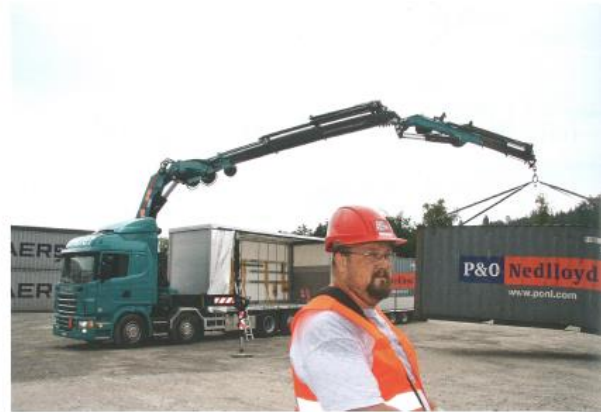
Der neue Scania G440 LB 6×2*4 verfügt hinter dem Fahrerhaus über einen 23,5- mt-Kran , den Fahrer Marco Graf bereits bestens im Griff hat.
